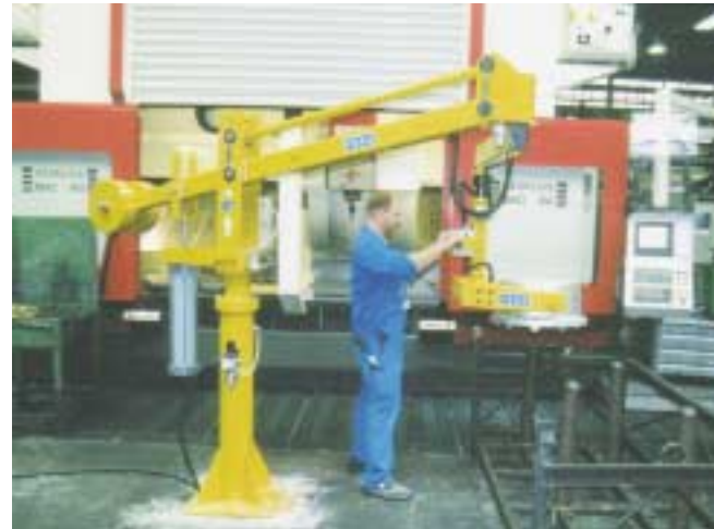
Bild 2: Handhabungsgeräte ermöglichen das Bewegen von Lasten ohne große Kraftaufwendung – das Bild zeigt einen Manipulator zur Maschinenbestückung
