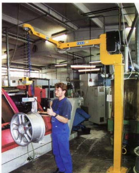
Die Hebehilfe mit Knickgelenkausleger ist eine Alternative zum Kran
