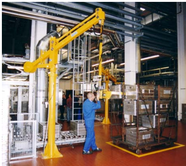
Bis zu 60 kg wiegen die Kisten, mit denen die Cellasto-Bauteile bei der BASF-Tochter Elastogran entlang der Prozesskette bewegt werden.
