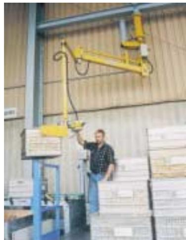
**Bild 2: Dank Manipulator werden Kisten im Außenbereich der Verlade-rampe praktisch schwerelos verladen**
